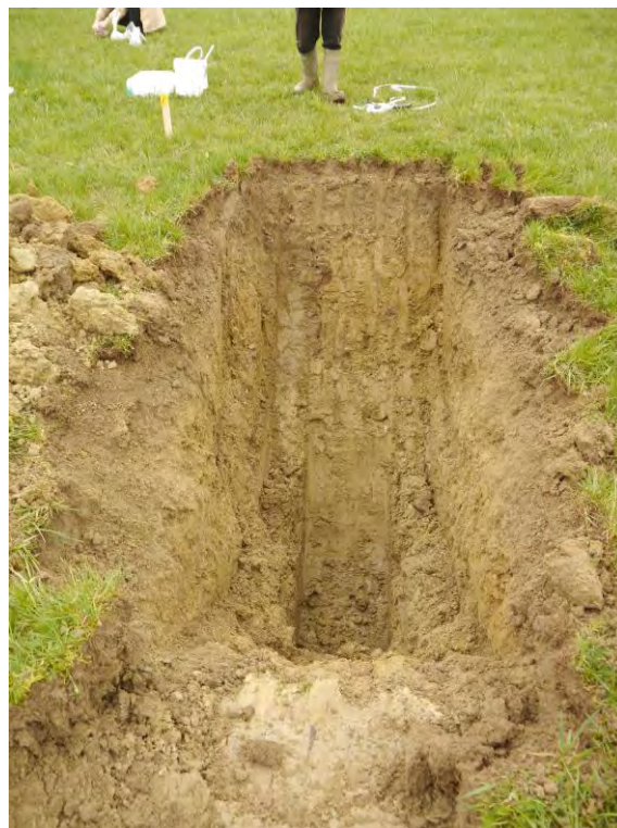
Abb.4: Schurfgrube SG 2/14 Bodenprobenentnahme, Brachwiese, Schmalegg
