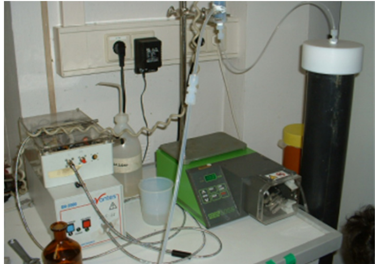
Abbildung 4-17: Aufbau des Retardationsversuchs mit gekühlter Säule
