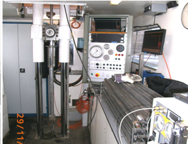
Abbildung 7-3: Durchführung der Direct-Push-Sondierungen entlang der Testfeld-Transekte mit Hydraulikstempel für kontinuierlichen CPT- und MIP-Vortrieb
