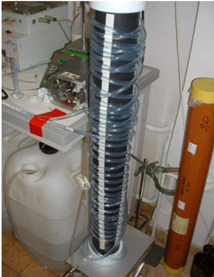
Abbildung 4-17: Aufbau des Retardationsversuchs mit gekühlter Säule
