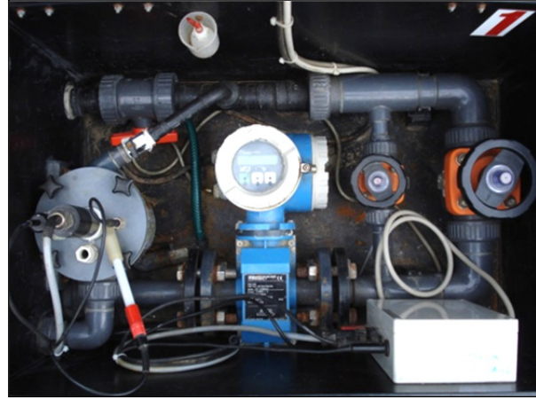
Abbildung 5-7: Versuchseinrichtung im innerstädtischen Bereich mit Einzäunung, Verkehrssicherung und Überfahrtschutz für die Ablaufschläuche (links) sowie Durchflussmess- und Regelsystem (rechts)
