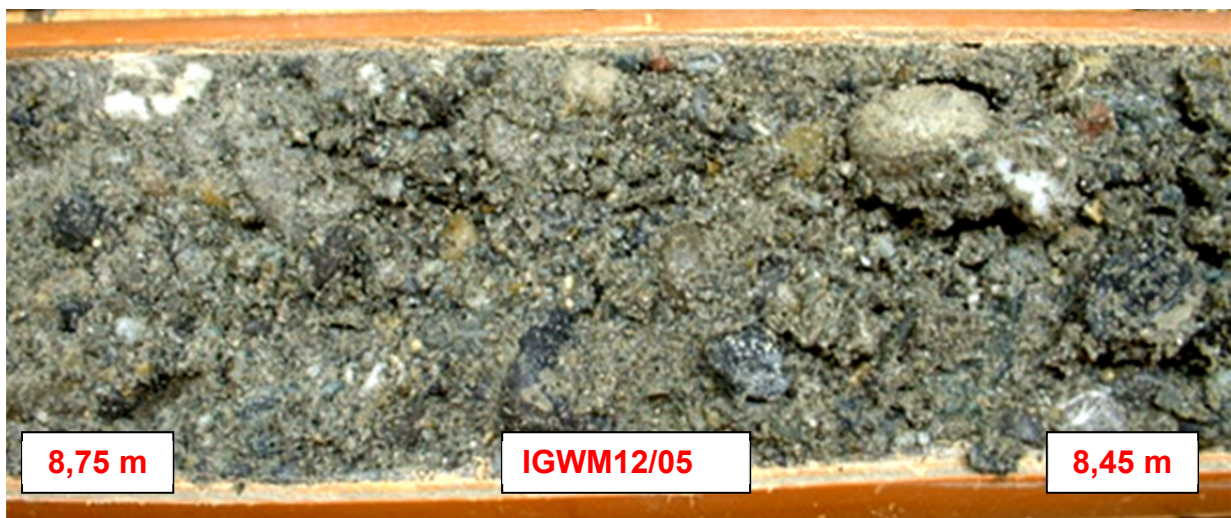
Abbildung 4-16: Probenmaterial im aufgetrennten Liner der Bohrung IGWM12/05
