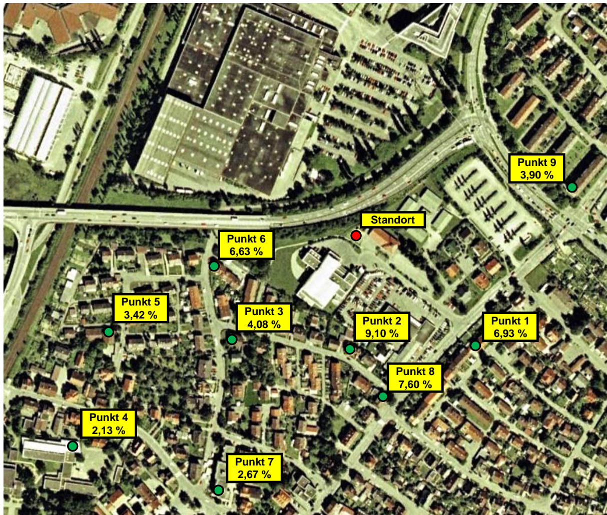
Abb. 1: Umgebung des geplanten Standortes, Lage der betrachteten Punkte sowie Ergebnis der Immissionsberechnungen.
