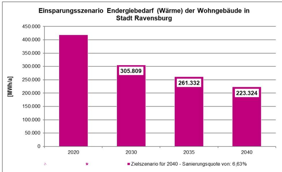
Diagramm 16: Sanierungsziele der Gebäudesanierung gemäß KfW - Effizienzhaus 100
