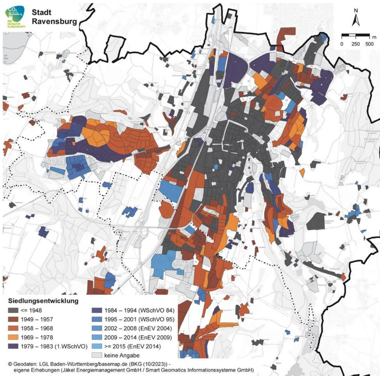
Abbildung 2: Wärmebedarfsstruktur - Gebäudealtersklassen
