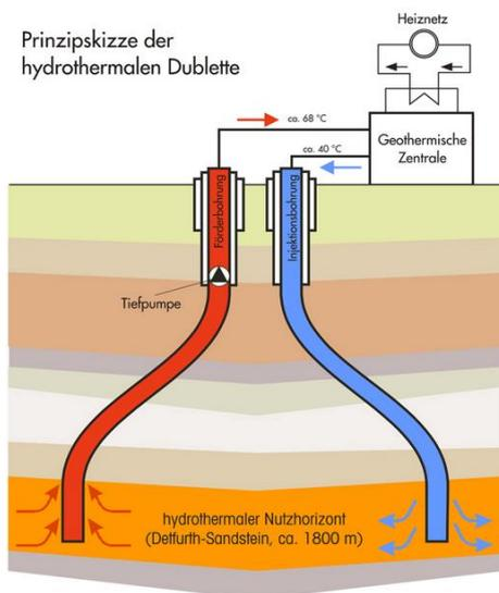
Abbildung 13: Hydrothermale Dublette – Schematische Darstellung<sup>13</sup>
