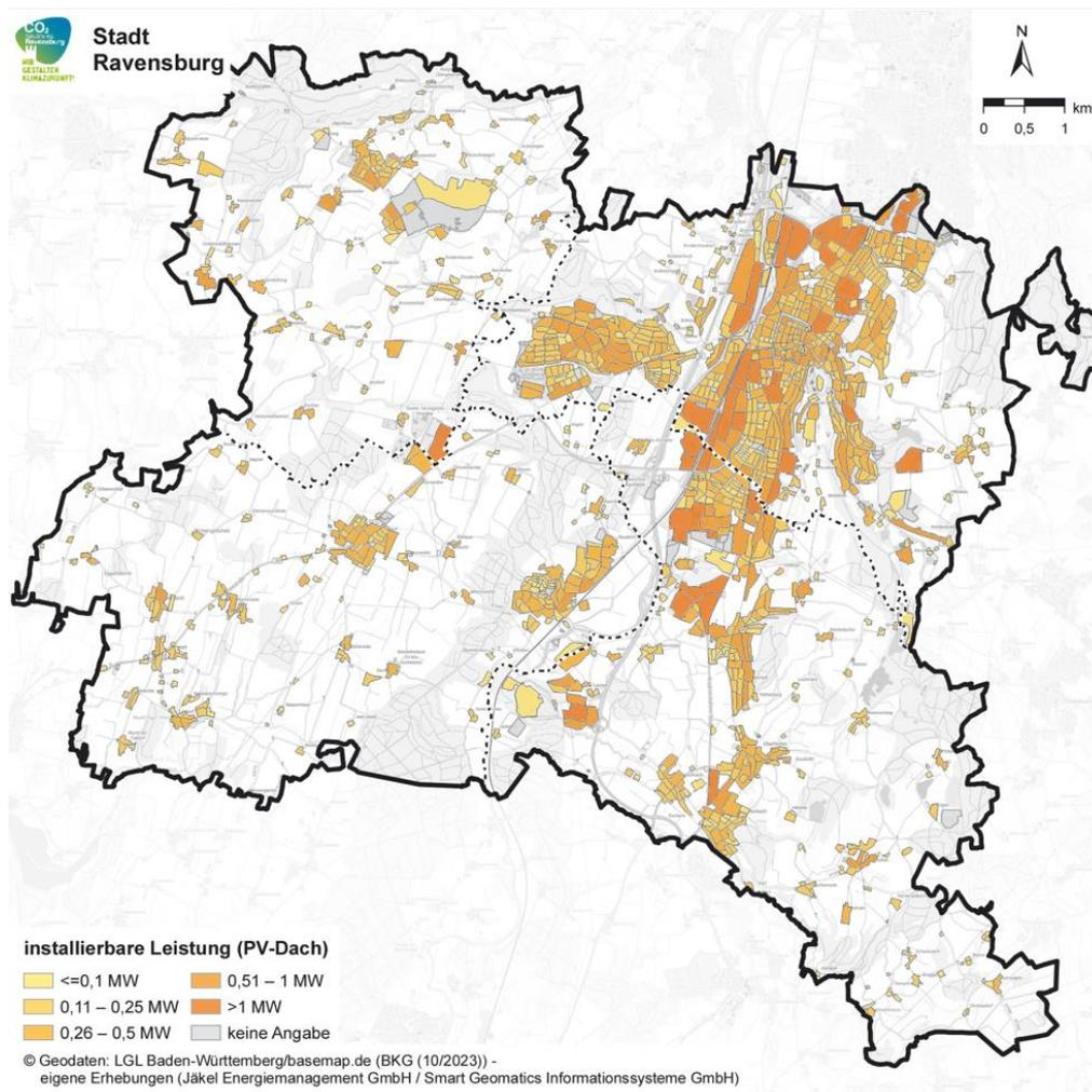
Abbildung 18: Potentialdarstellung – PV-Dachleistung
