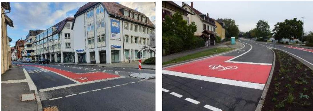
Abb. 32: Aufgeweitete Radaufstellstreifen in Herrenberg (links) und Emmendingen (rechts)
