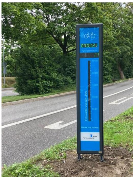
Abb. 51: Bestehender Fahrradbarometer (Dauerzählstelle) in Ravensburg
