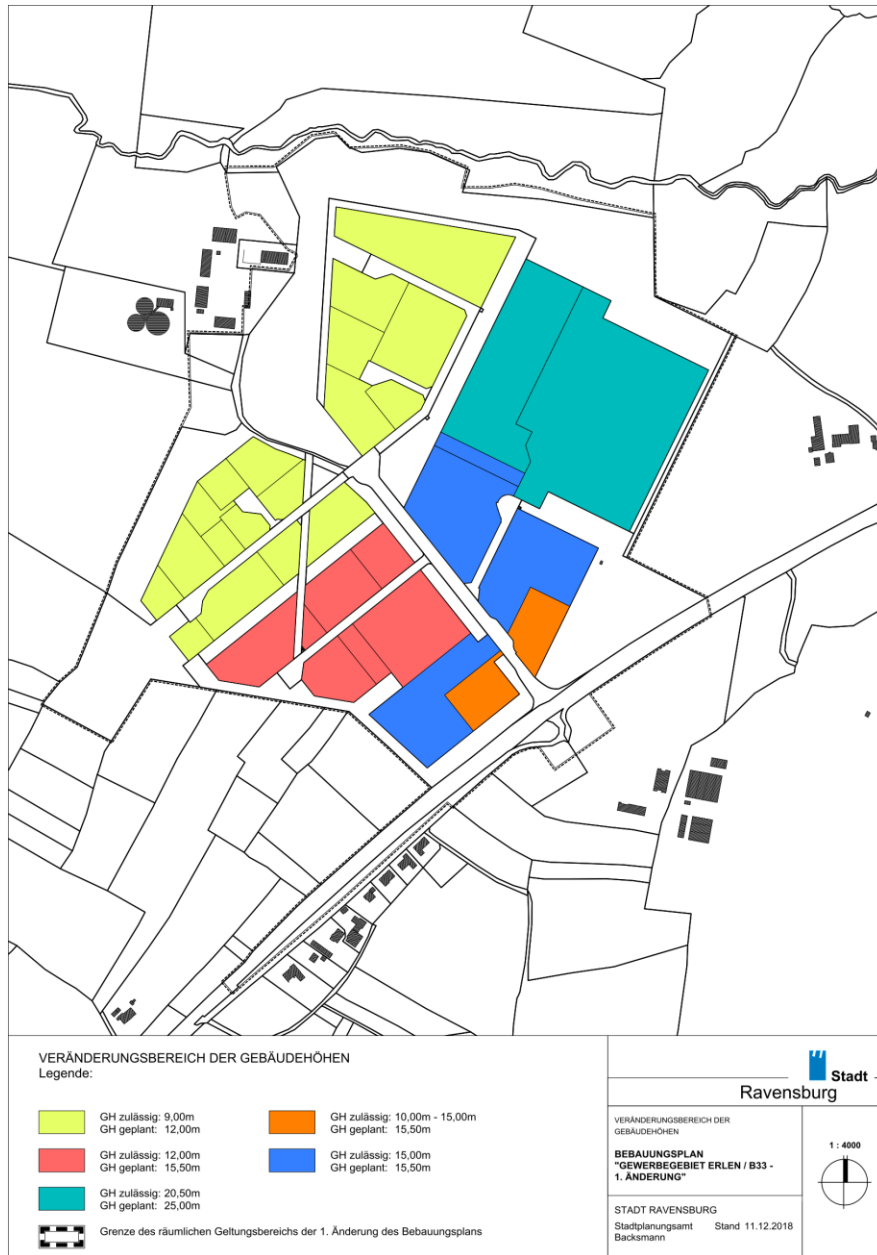
Abbildung A-2: Zulässige Bauhöhen
