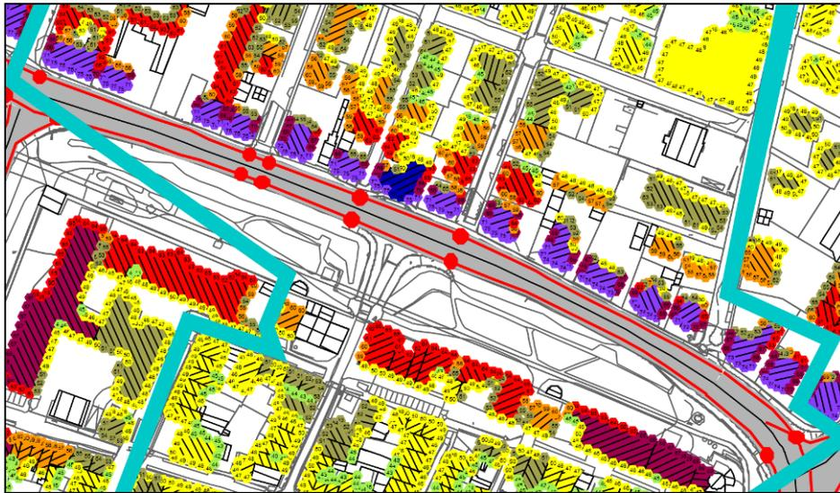
Abbildung 5: Auszug aus einer Gebäudelärmkarte L<sub>Tag</sub>
